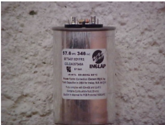
Celda capacitiva con resistencia de descarga
